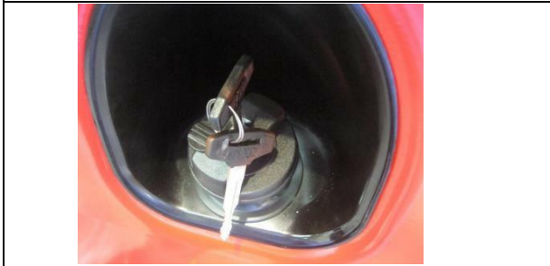
Tampa do reservatório de combustível com trava
