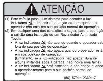
Esta empilhadeira está equipada com o sistema OPS (Sensor de Presença do Operador). Antes de iniciar a operação da empilhadeira, verifique se todas as funções do sistema OPS estejam funcionando corretamente. (Modelos equipados com embreagem não possuem as funções de operação OPS.)
